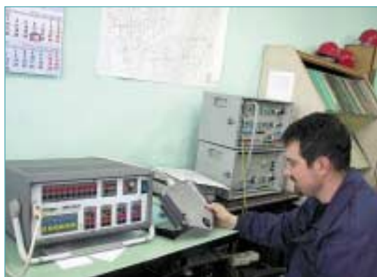
Група “Релейна защита и автоматика” в цех “ОРУ” разполага със съвременна техника за изпитване на релейни защиты
